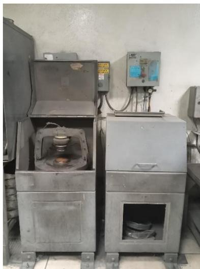
*Figura 11. Pulverizadores de discos. Fuente: elaboración propia, 2022.*
