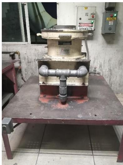
*Figura 9. Quebradora de cono. Fuente: elaboración propia, 2022.*
